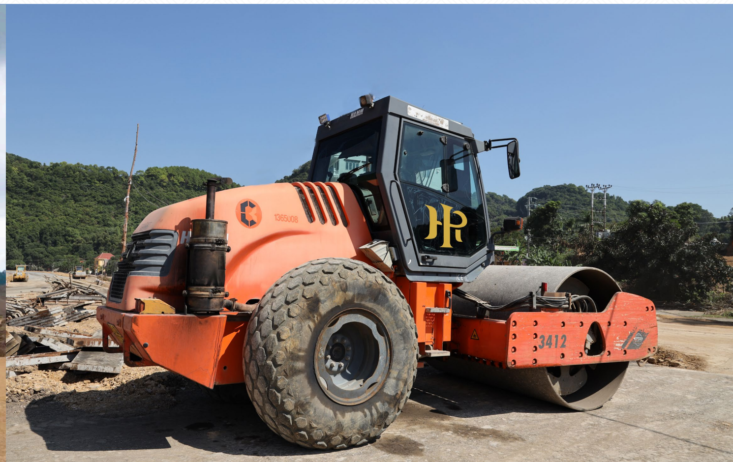
Xe Lu rung Hamm 3412 thi công Gói thầu số 27 dự án Đầu tư cải tạo nâng cấp đường 356 đoạn qua xã Xuân Đám
