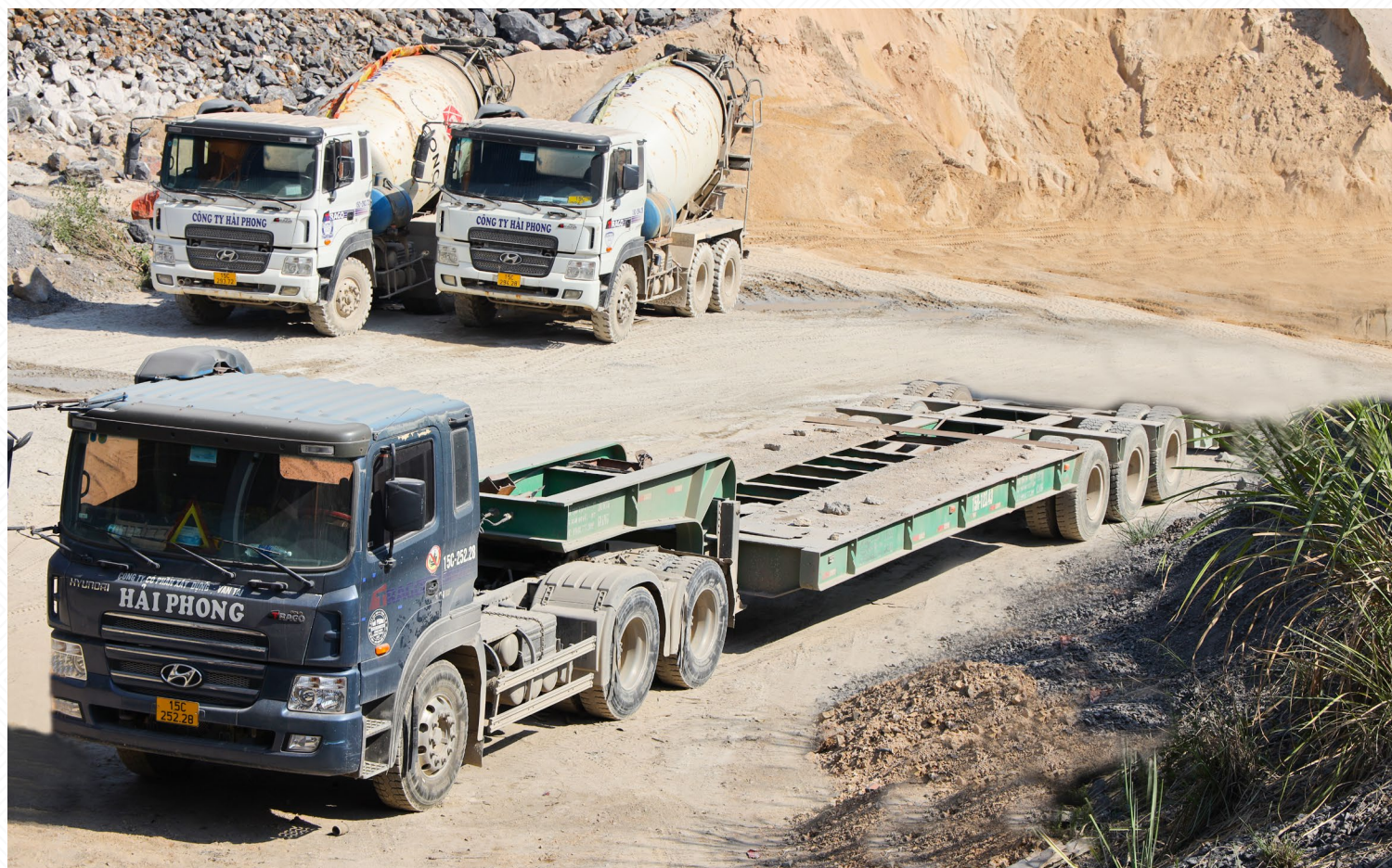
Sơmiromoc tải ( chở xe máy chuyên dùng tối đa 45t)
